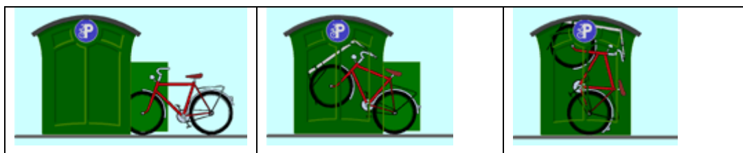
Bild 5. Cykelboxen Pendula, ett svenskt patent. Rymmer 8 cyklar i individuella bås. Tar 5,4 kvadratmeter i anspråk. I Linköping finns en uppsättning om 5 boxar intill centralstationen (se vidare bilaga 2).
